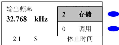
此时，通过旋钮，可更改存储序列（1~9），然后再按一下【存储】对应的靠近右边框的按键，存储调用对话框消失，界面恢复正常，存储成功。
